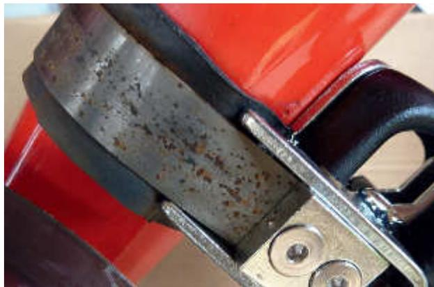
Das fehlerhafte Band kann leichten Rostbefall aufweisen.
